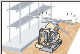
建設工事現場での不意の落下物
